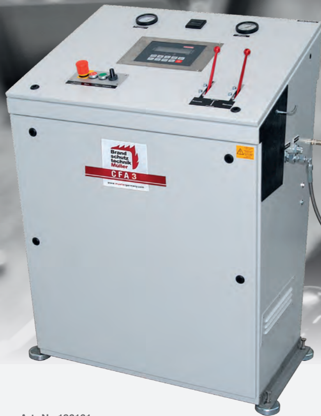
• Art.-Nr. 186161 Mit der Kohlendioxid-Füllanlage CFA 3 können CO 2 -Feuerlöscher oder CO 2 -Flaschen bis 50 kg gefüllt werden.
