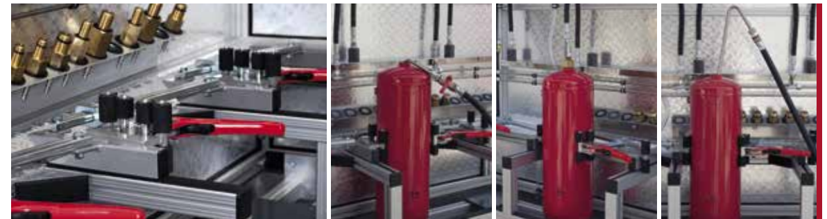
• Befüllen. • Druckprüfung. • Entleeren.
